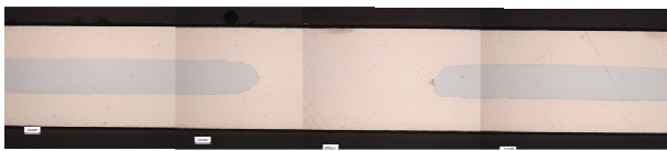
Fig.7. Coupe transversale du substrat CPTH.
