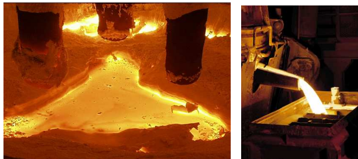
Fig.1 Fusion et coulée du THTZ
