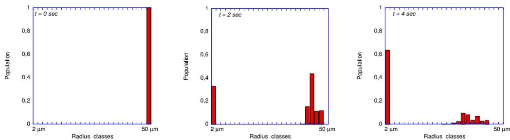
FIG. 3 – Histogrammes de densité massique de distribution de rayons de particules pour les classes comprises entre 2  $\mu\text{m}$  et 50  $\mu\text{m}$  à différents instants :  $t = 0$  s, 2 s et 4 s.
