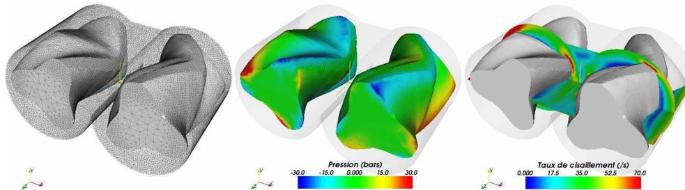
FIG. 1 – Représentation, dans le maillage de calcul, de la surface des rotors d'un mélangeur interne par isoaleur à zéro de la fonction *level set* de chaque domaine solide représentant un rotor (gauche), carte du champ de pression (centre) et des taux de cisaillement (droite) calculés.
