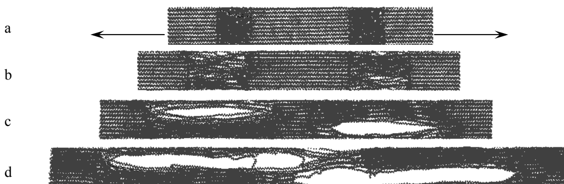
Figure 2: Evolution du système semi-cristallin au cours du temps ; a, état initial ; b, \lambda = 0.2 ; c, \lambda = 0.5 ; d, \lambda = 1
