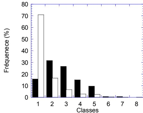
Figure 2. Distribution granulométrique des longueurs des sciures fines obtenues avec Visilog (noir) et FQA (blanc). Les classes de longueur sont celles décrites dans le Tableau 2.
