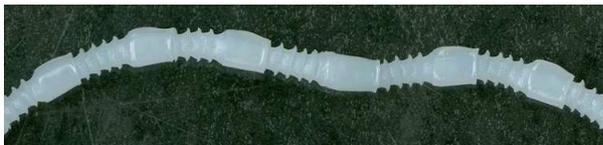
Figure 1. Défaut oscillant d'un polyéthylène métallocène (mPE)
