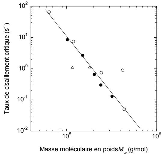
Figure 7. Variation du taux de cisaillement critique en fonction de la masse moléculaire  $M_w$  d'une série de polybutadiènes; données de (●) Vinogradov et al. [14], Yang et al. [11] (○) et Wise et al. [36] (Δ).
