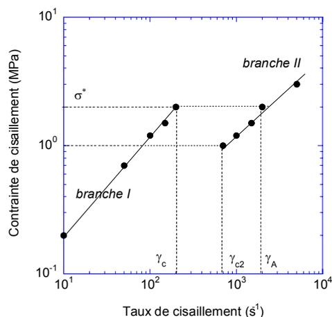
Figure 2. Courbe d'écoulement caractéristique d'un polymère linéaire
