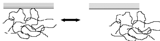
Figure 3. Désorption des molécules adsorbées
