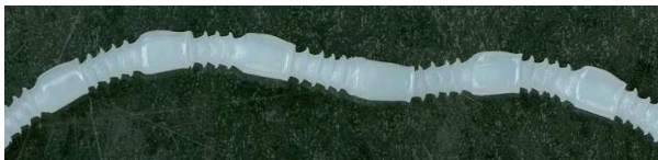
Figure 1. Défaut oscillant d'un polyéthylène métallocène (mPE)
