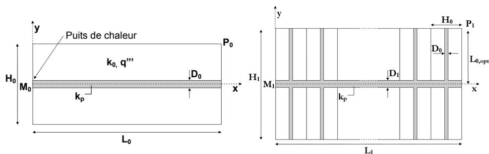
Figure 1 – Paramètres géométriques du volume élémentaire et du 1<sup>er</sup> niveau constructal
