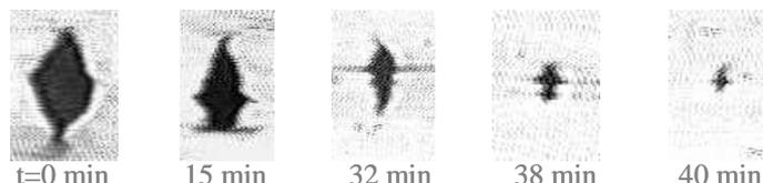
FIG. 6 – Illustration du mécanisme d'érosion. Noir N234/SBR.  $R_0 = 22\mu\text{m}$ ,  $\dot{\gamma} = 6\text{ s}^{-1}$ . Mécanisme observé dans le plan écoulement/vorticité. Figure extraite de [1].
