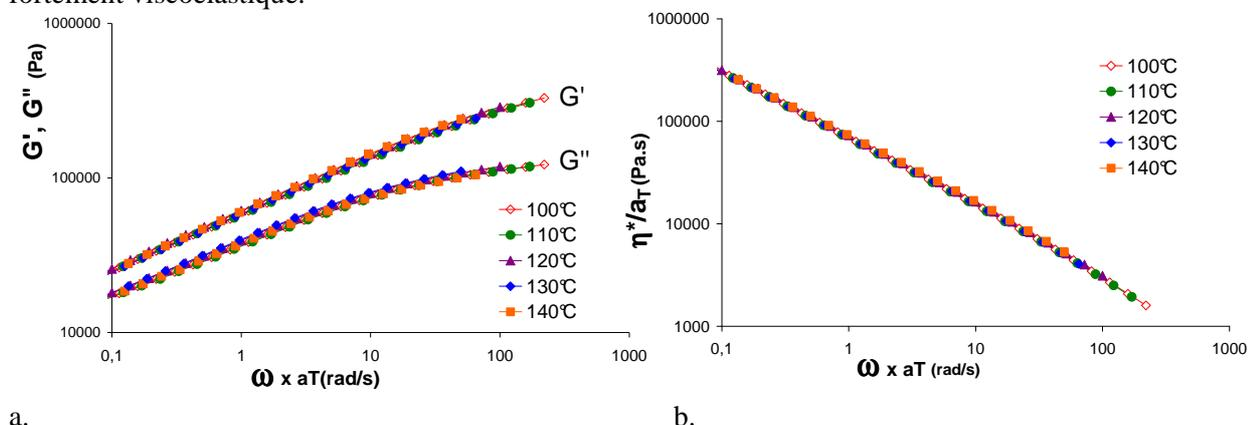
FIG. 4 – Courbes maîtresses a. des modules élastiques et visqueux, b. de la viscosité complexe en fonction de la fréquence du SBR 25E à la température de référence de 140°C.
